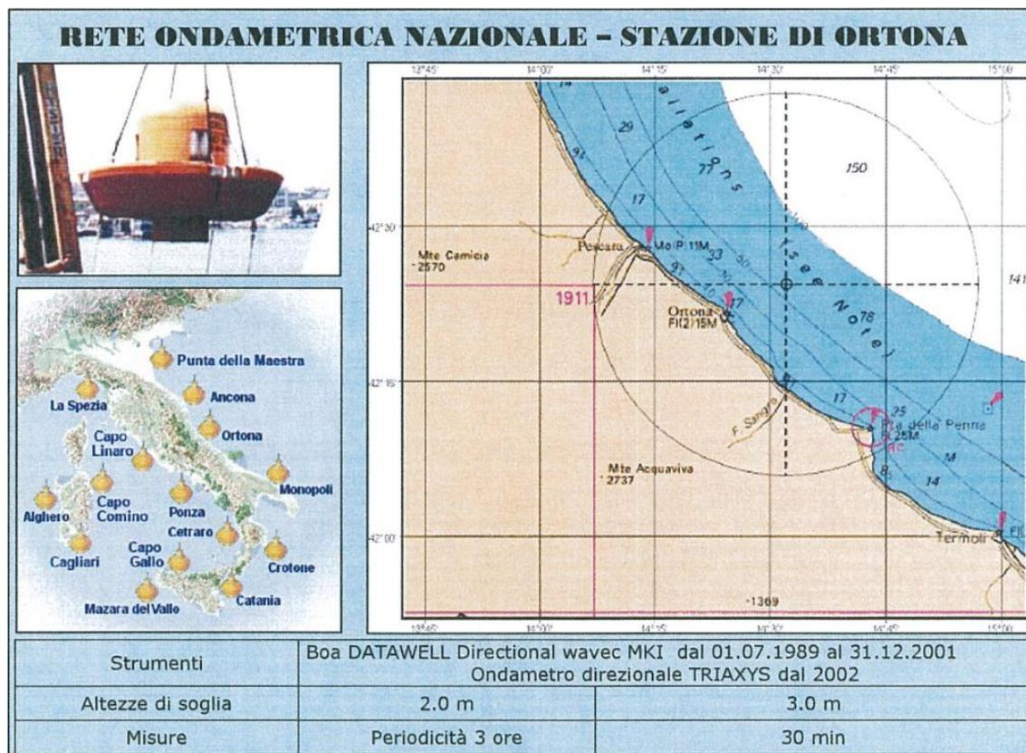
Figura 3.1 - Dati della stazione ondametria di Ortona.
